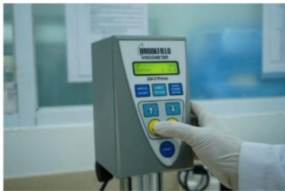
Gambar 4. Alat yang digunakan untuk memeriksa viscositas yaitu viscometer Brookfield
