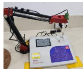
Gambar 3. pH diukur dengan menggunakan pHmeter. Uji viskositas merupakan uji untuk menentukan nilai kekentalan suatu zat.
